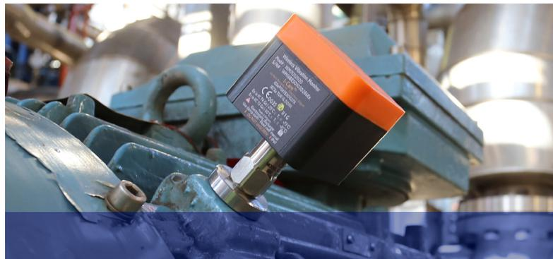
*Gracias a los análisis en profundidad y a nuestro diagnóstico, pudimos implementar, junto con el cliente, soluciones sostenibles para hacer sus equipos más fiables”*. Esta solución se llama Wi-Care, sensores inalámbricos que realizan análisis de vibración y temperatura de los activos y envían los datos a I-see, una plataforma en la nube desarrollada internamente y que notifica a todos los técnicos implicados cuando los valores sobrepasan los límites estipulados previamente.
